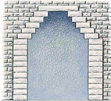
রেখাচিত্র-৩ : ক্রমপ্রলম্বন পদ্ধতিতে নির্মিত খিলান
